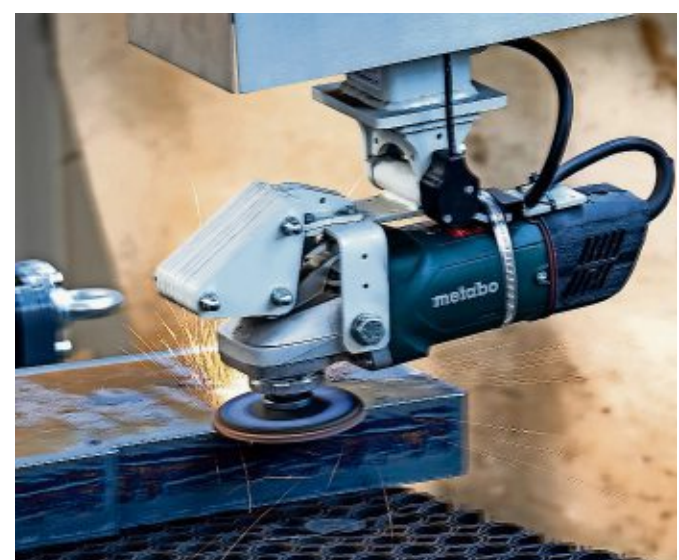
Stahlplatten haben nach dem Zuschneiden oft scharfe Kanten und Grate. Der Roboter bearbeitet die Kanten in gleichbleibender Industriequalität.
