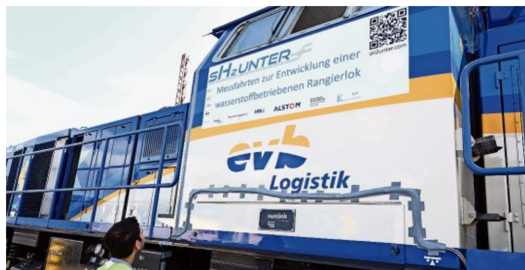
Diese EVB-Rangierlok vom Typ Vossloh G1000 ist mit Mess-Sensorik ausgerüstet worden, um den zukünftigen Wasserstoffbedarf zu bestimmen.
