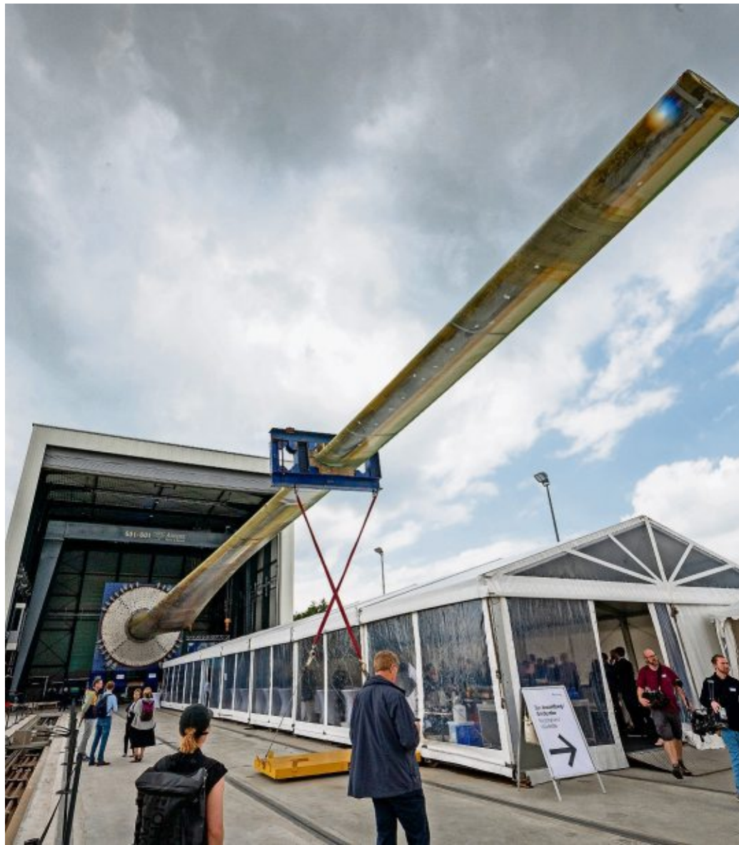
Auf dem neuen Rotorblatt-Prüfstand des Fraunhofer Iwes können Rotorblätter mit mehr als 115 Meter Länge getestet werden.
