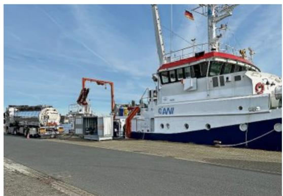
Das Forschungsschiff „Uthörn“ wird in Bremerhaven betankt. Die mobile Bunker- und Blendinganlage befindet sich in einer Art Metallschrank. FOTOS: UTG/PR
