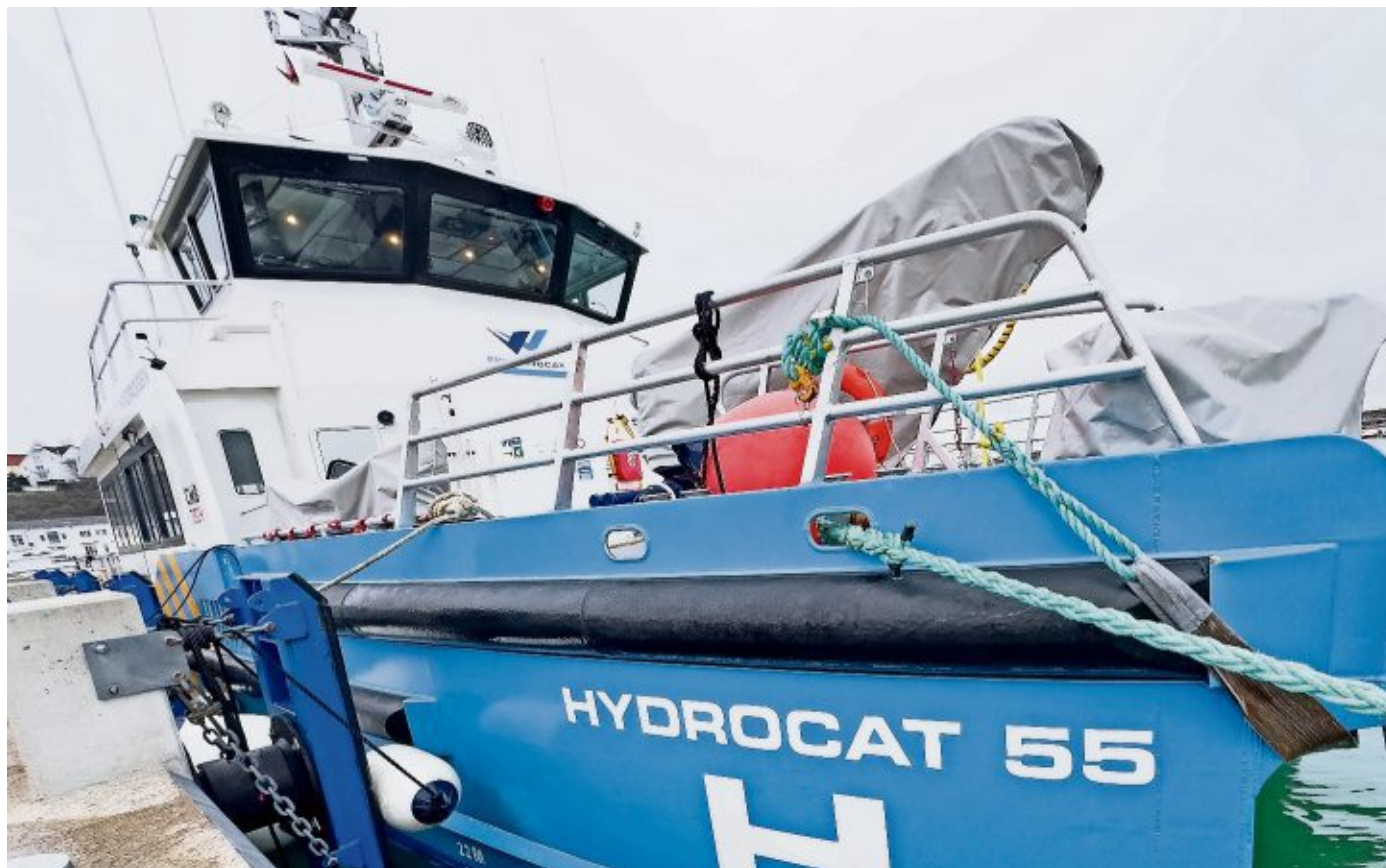
Die „Hydrocat 55“ ist laut dem Betreiber ein Pionier. Weil das Schiff zumindest teilweise mit Wasserstoff fährt, sollen der CO 2 -Ausstoß und die Stickoxid-Emissionen gesenkt werden. FOTO: SAUER/DPA
