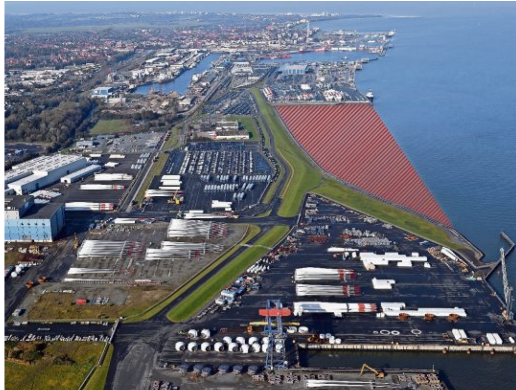
Mehr Platz für den Windkraft-Umschlag: Der Cuxhavener Hafen soll um 38 Hektar (rote Fläche) wachsen. Wenn der Ausbau fertig ist, verfügt die Stadt über eine mehr als 4 Kilometer lange Kaje. FOTO: SCHEER
